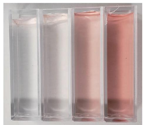
図1 X線照射後のPBSポリマーゲル線量計
