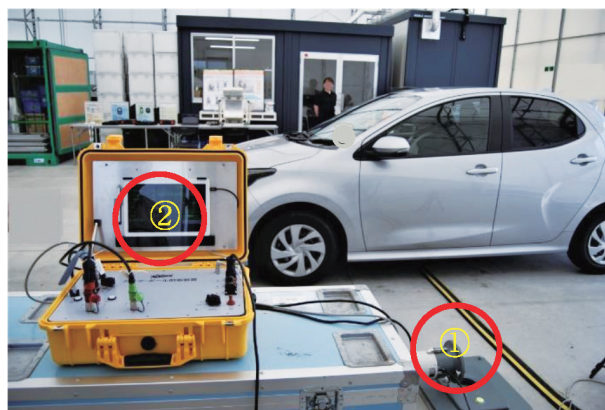
写真5. ガンマ・ポール検査機を通過中の車
