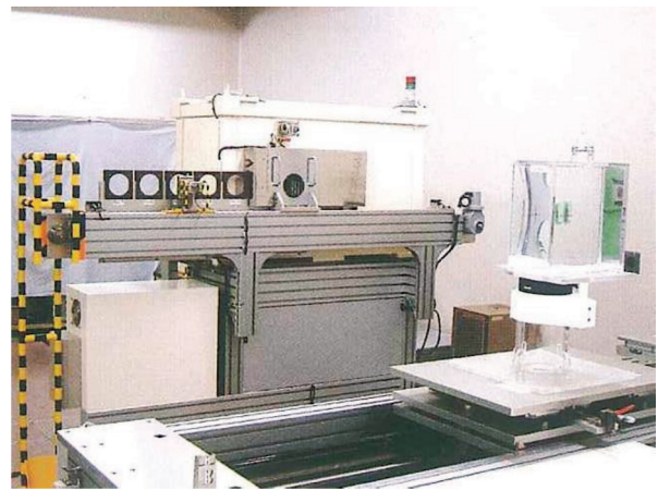
写真7. 軟X線・中硬X線照射装置 （写真提供：千代田テクノル）
